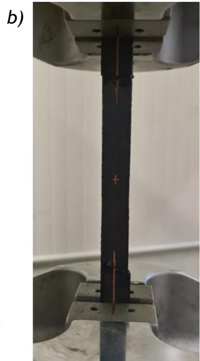
Figure 15 : a) Résultat d'un essai de traction sur un composite polymère renforcé unidirectionnellement par des fibres de carbone longues et b) photo du dispositif expérimental
