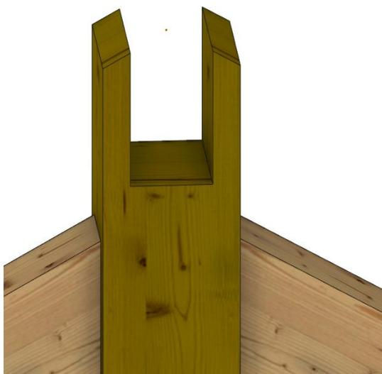
L'enfourchement délardé de la tête du poinçon est réalisé
