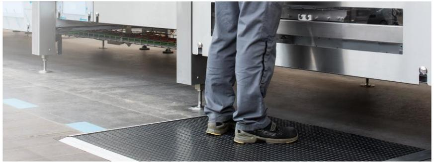
Pour gérer les sécurités électriques, il faut installer un détecteur de sécurité « DS1 » de type tapis de pression de la marque ASOSAFETY (à deux contacts NC). Celui-ci assure la détection de la non-présence d'une personne dans la zone dangereuse de passage du mur. Il a pour dimension 1m / 0.75m.
