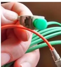
Dans les prises et sur les capuchons, on trouve des capuchons de protection, ils servent à protéger la prise de la saleté et de la poussière ainsi que les yeux d'un éclairage accidentel. Il convient de les laisser en place tant qu'une prise n'est pas raccordée.
