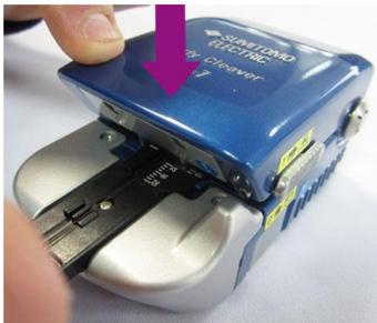
Appuyer sur le couvercle : la fibre est coupée et la chute est recueillie dans le réceptacle amovible.
