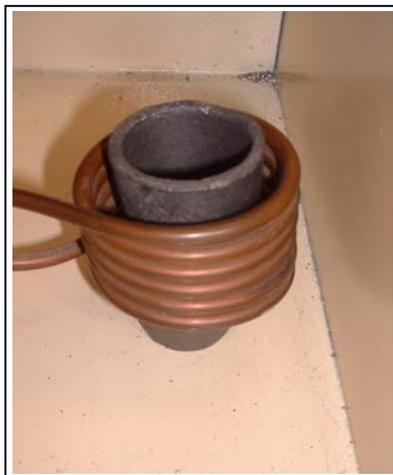
Figure 20 : Solénoïde inducteur pour chauffage à induction
