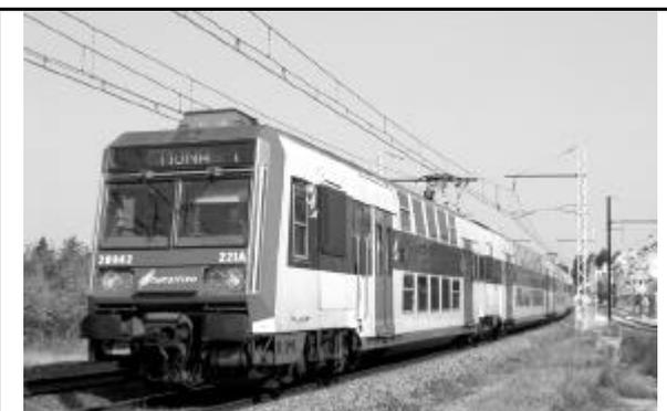
**Figure 248** Vue d'une rame bicourant Z 20500 à 2 niveaux. Les 2 motrices de 1500 kW utilisent les équipements, à moteurs asynchrones et onduleurs de courant, expérimentés sur la Z 8895.
