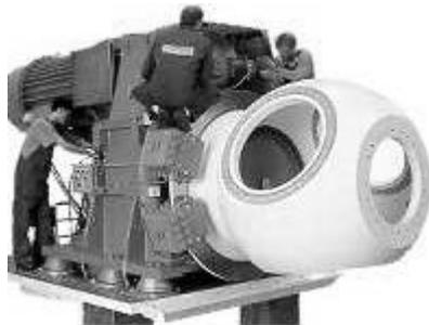
Figure 6 : Le châssis et la coquille de la nacelle
