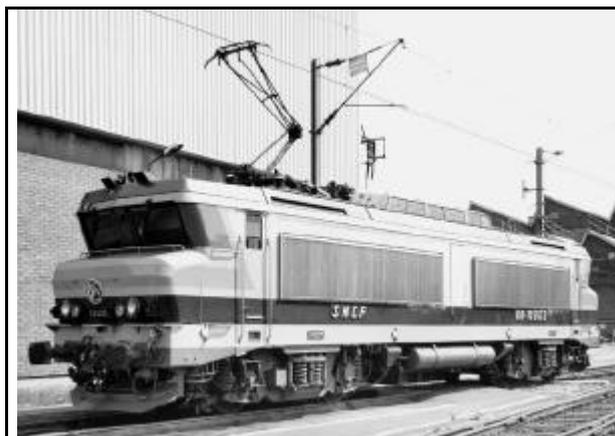
**Figure 233** *Vue de la locomotive expérimentale BB 10003 à 4 moteurs asynchrones alimentés par onduleurs de tension. Cet engin de 92 tonnes pouvait développer une puissance de 5000 kW jusqu'à la vitesse maximale de 160 km/h .*
