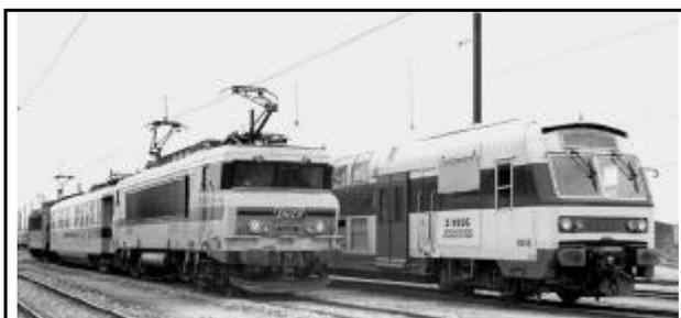
**Figure 245** Vue de la Z 8895 expérimentale (ici, au côté de la BB 10003 accouplée à une voiture de mesures électrotechniques). Cette automotrice bicourant de banlieue à 2 motrices de 1500 kW, avait 8 moteurs asynchrones de 375 kW alimentés par onduleurs de courant.
