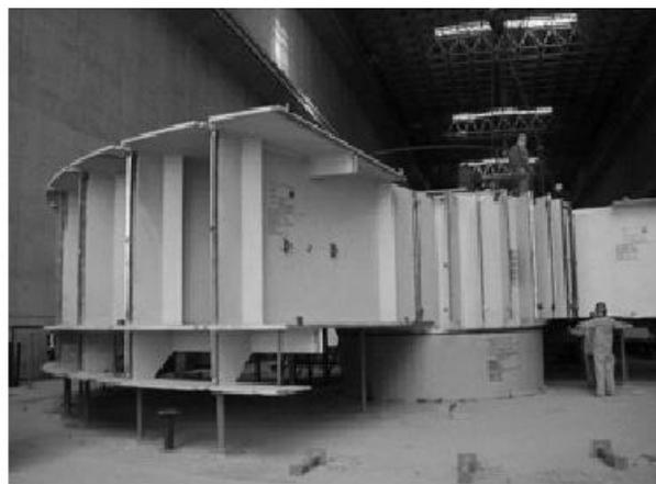
Figure 7 : Mise en place et soudage des secteurs du croisillon rotor
