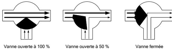
Figure 9 : Principe d'une vanne trois voies
