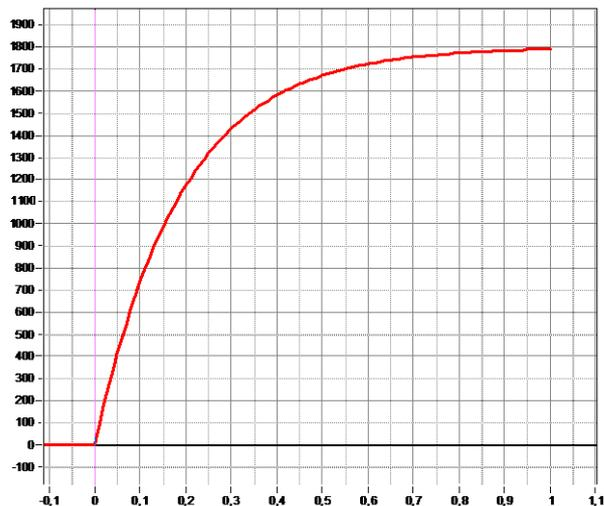
Figure 20 : Allure de la vitesse en boucle fermée avec correcteur PI
