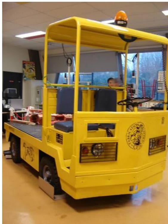
Figure 1 : photo du chariot autoporteur 2 tonnes
