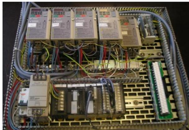
Figure 7 : Platine de commande en cours de réalisation par les étudiants (API + variateurs + annexes)
