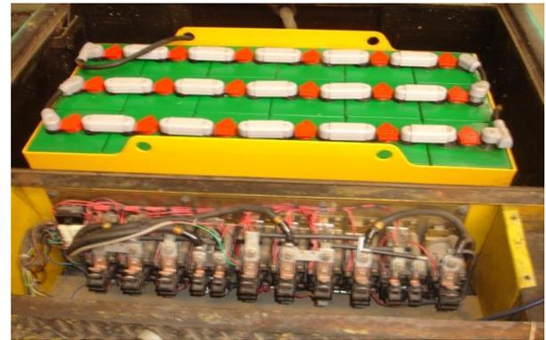
Figure 4 : photo des contacteurs de puissance et de la batterie d'accumulateurs du véhicule électrique, avant rénovation
