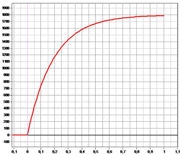
Figure 18 : Allure de la vitesse en boucle ouverte
