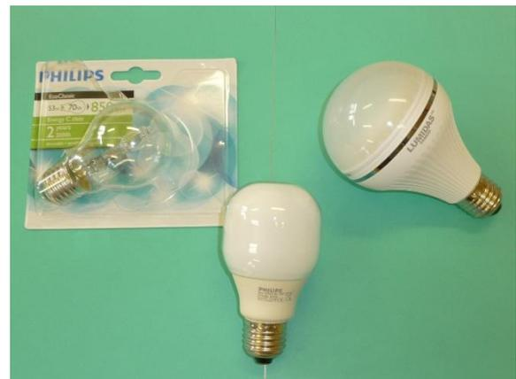
Figure 1 – Lampes étudiées (Halogène à gauche LED à droite, fluo-compacte en bas)
