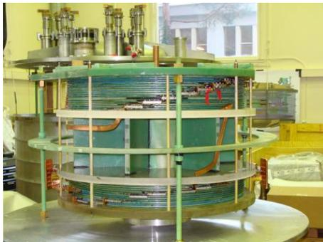
Figure 8 : SMES II avec deux enroulements électriquement indépendants.
