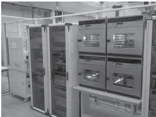
Figure 6 : Banc de vieillissement
