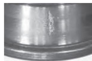
**Figure 7** Ecaillage sur un chemin de roulement [2]
