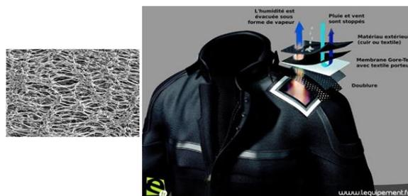
Par ce biais, la membrane Gore-Tex offre des propriétés d'étanchéité et de respirabilité, limitant donc la conductivité thermique due à la présence d'humidité, susceptible de générer un refroidissement plus rapide.
