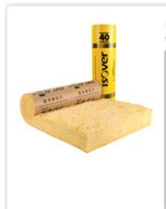
Descriptif : Rouleau en laine de verre lambda 0.040 revêtu sur une face d'un pare vapeur Kraft autodéroulant à l'ouverture de l'emballage. Isolation thermique et acoustique des combles perdus et des combles aménagés. Certificat Acermi.
