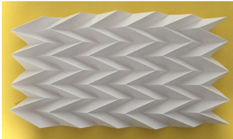
Figure 12 : Pliage avec le motif Miura Ori
