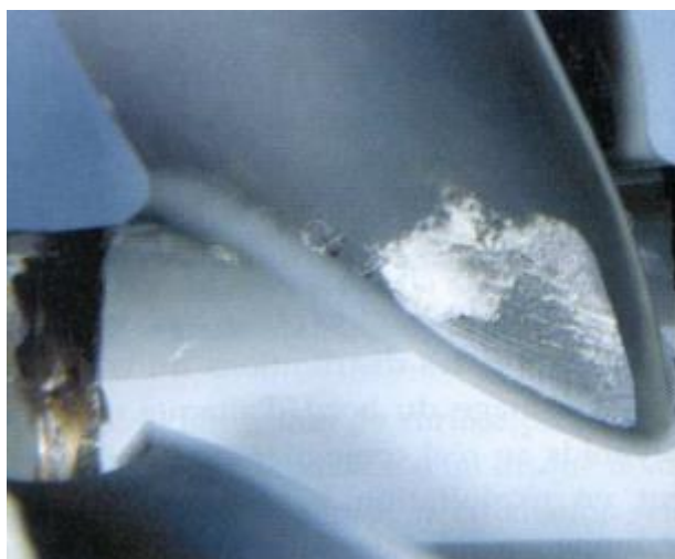
Figure 11 : Cavitation à poche partielle (photo BEC)
