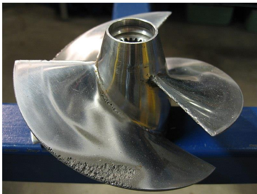
Figure 1 : Hélice endommagée par la cavitation [6]
