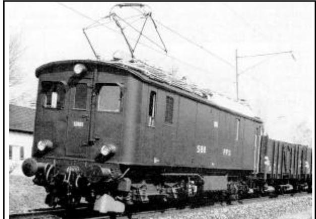
**Figure 219** Locomotive expérimentale Be 4/4 12001 des Chemins de Fer Fédéraux suisses ( CFF ) à 4 moteurs asynchrones et onduleurs de tension à thyristors.
