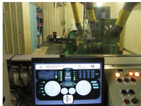
Figure 8 : Banc d'endurance pour boîte de vitesse de véhicule électrique
