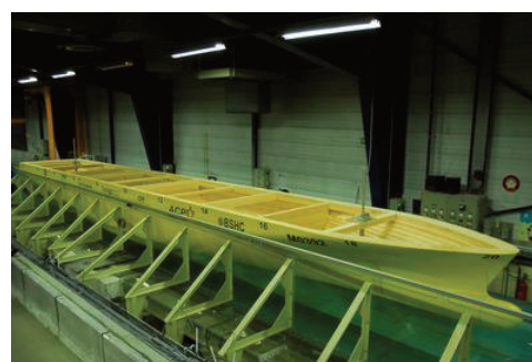
Figure 19 : Modèle au 1/30e des futures écluses du canal de Panama
