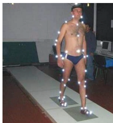
Figure 14 : Banc de mesures de signaux biomécaniques
