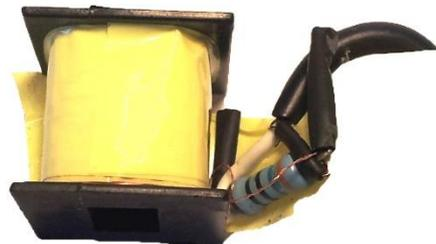
Figure 4 : une résistance R1 est placée en parallèle aux bornes de la bobine
