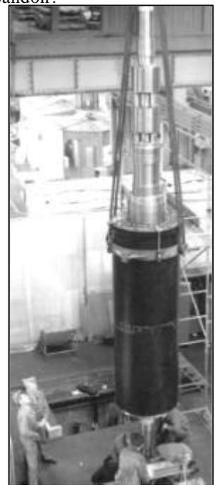
Figure 10 :Rotor d'un alternateur supra (Alstom)
