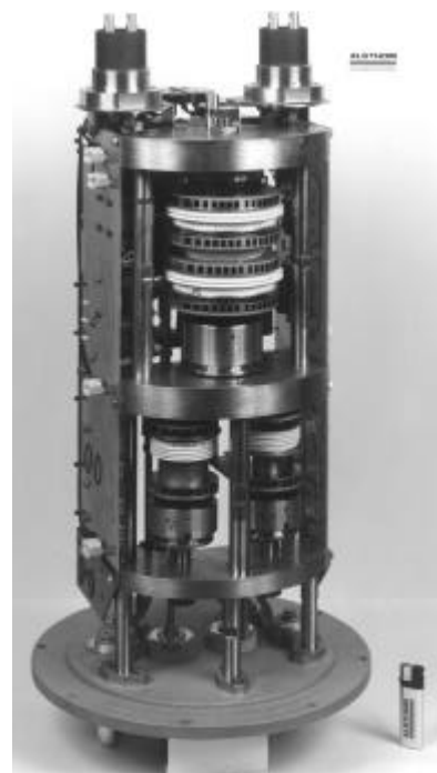
Figure 175 Vues représentatives de la technologie de refroidissement par immersion des semi-conducteurs dans un liquide caloporteur bouillant vers 47 ° C. Les cellules sont montées en compression selon une structure en forme de colonne qui est supportée par le flasque arrière de fermeture de la cuve, au travers duquel passent les connexions de puissance terminées par les broches mâles de connexion au bloc ; les circuits annexes sont aussi installés au plus près.
