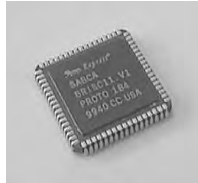
Processeur BRISC2 dédié aux applications avioniques
