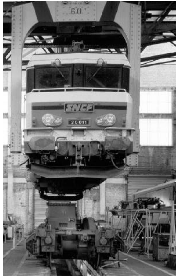
Figure 170 La BB 20011 en cours de montage aux ateliers SNCF d'Hellemmes. La caisse, complètement équipée, va être descendue sur ses bogies restés au sol ; la masse totale de la locomotive, en ordre de marche est de 90,5 t.
