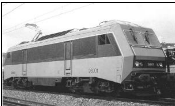
Figure 176 Vue de la BB 26001, premier exemplaire des 234 locomotives bicourant à moteurs synchrones autopilotés de 5600 kW. Ces puissantes machines de 90 tonnes peuvent rouler à 200 km/h avec un effort résiduel de 10000 daN. ( cliché ALSTHOM )
