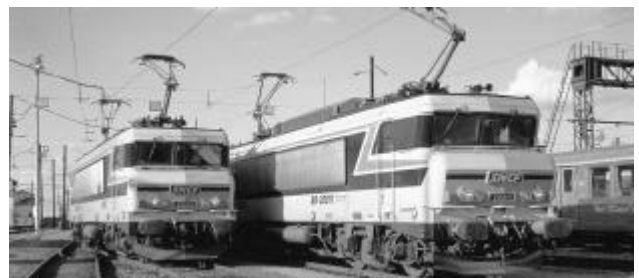
Figure 171 Les locomotives "jumelles" BB 20011 et 20012 de 5600 kW, à moteurs synchrones autopilotés. Ces engins bicourant, aptes au 200 km/h, ont préfiguré les BB 26000.
