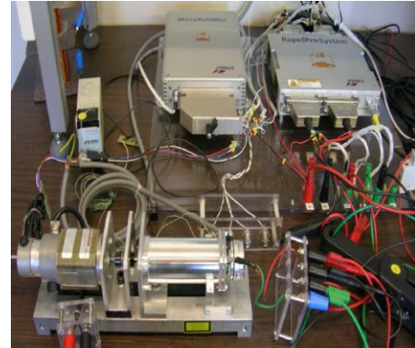
Figure 4 : Le banc d'essai de la machine Syncrel
