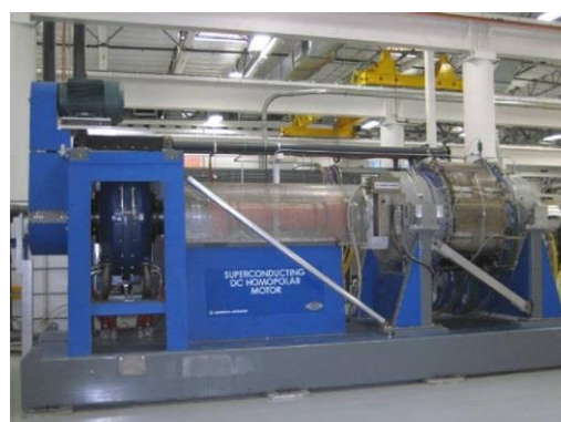
Figure 2 : Moteur Homopolaire 3,7 MW, GENERAL ATOMICS [ http://www.ga.com/electric-drive-motors ]
