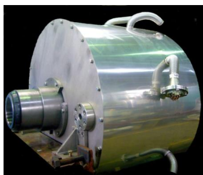
Figure 1 : Moteur à flux axial 365 kW – 250 tr/min, fabriqué par Sumitomo
