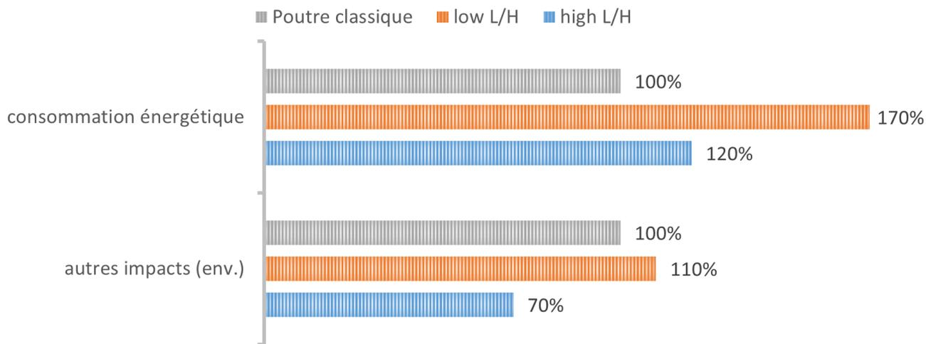
Figure 23 : Comparaison simplifiée des impacts environnementaux d'une poutre optimisée par rapport à ceux d'une poutre classique, à différents gains de béton [8]
