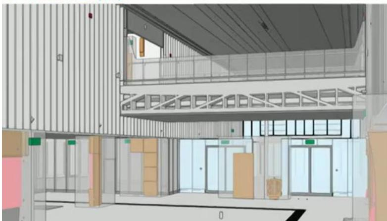
Figure 8 : Inclusion d'une telle poutre dans le chantier de la gare de Massy-Palaiseau
