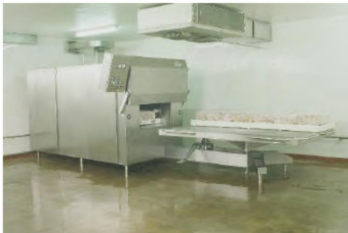
Figure 11 : Installation SAIREM de tempéragé de viande par micro-onde 915 MHz.
