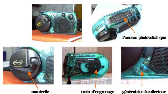
Figure 1 – Vue d'ensemble de la Radio S360
