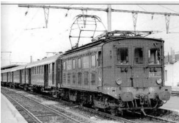
Vue de l'une des locomotives de la série des BB 1 à 80 construites entre 1924 et 1928 pour le réseau du P.O. La BB 17 a reçu le hacheur expérimental OERLIKON en 1970 alors qu'elle avait été radiée des effectifs du dépôt de Chambéry. ( photographie extraite d'un article de M. Bernard Collardey, revue "VOIES FERREES" n°92 de novembre 1995 )
