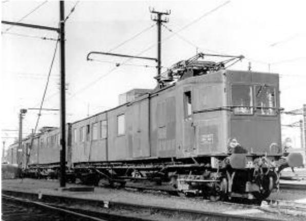
Les "vénérables" automotrices Z4001 et Z4002, à hacheurs expérimentaux, en stationnement au dépôt de Brétigny où elles étaient basées pour les essais.
