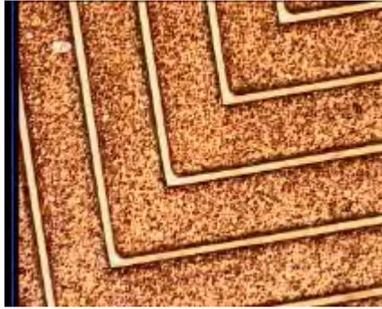
Figure 19 : Vue partielle de la partie cuivre d'une inductance en spirale (image du LAAS)
