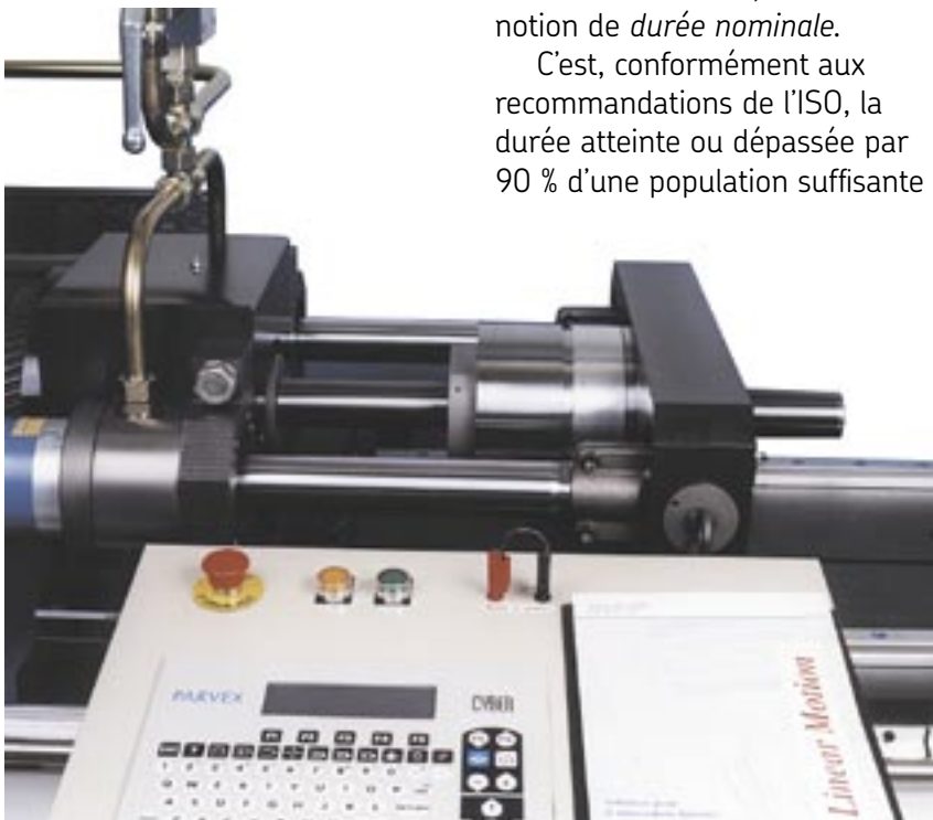
Banc d'essais de durée de vie
