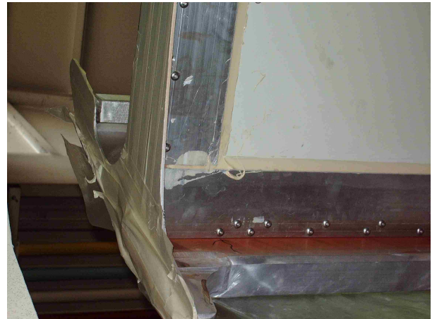
Figure 7 : panneau composite collé sur la structure
