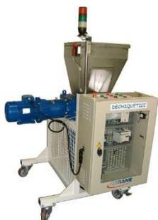
DECHIQUETICC est une machine industrielle exploitée dans le cadre de la gestion de recyclage de bouteille plastique.
