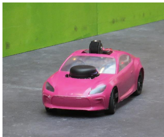
Figure 2 : Voiture réelle, avec le réseau de neurones issu de la simulation
