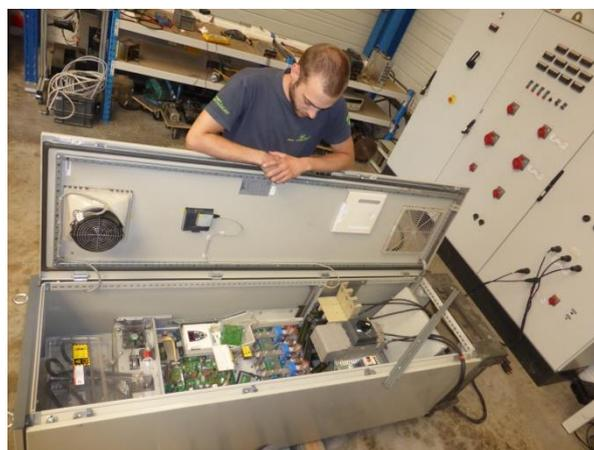
Figure 2 : Armoire du variateur ATV 61 de 200kW chez le réparateur
