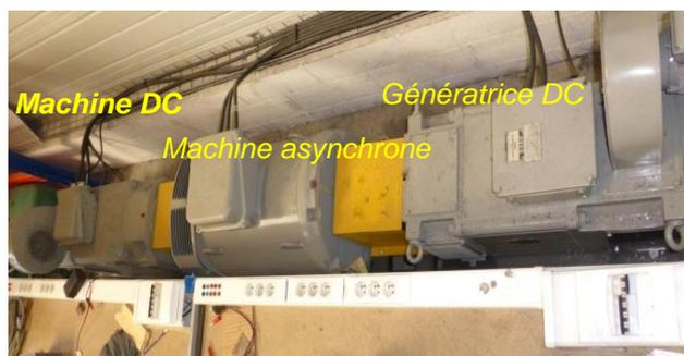
Figure 8 : motorisation pour variateur de 200kW (vue de dessus)
