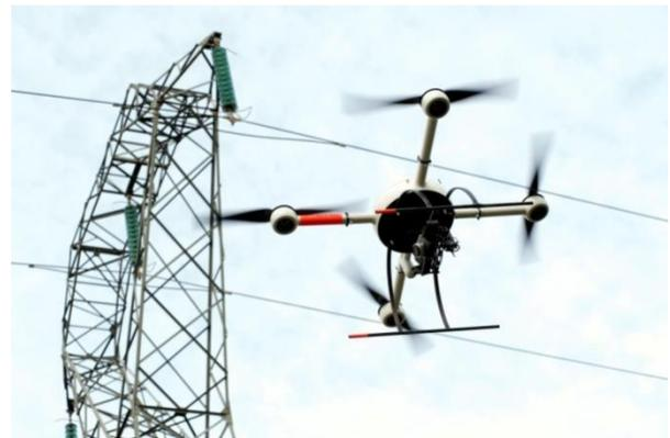
**Figure 6** : surveillance de ligne à l'aide d'un drone à TESE, le 24 avril 2012. Drone effectuant un survol des pylônes pour repérer leur corrosion. (© ROUX Lionel/RTE/2012)
