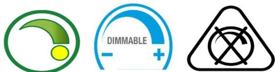
fig 8: Icône indiquant si l'ampoule peut être commandée ou pas
