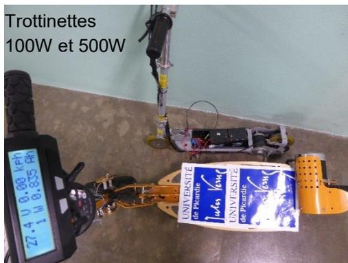
Figure 1: modèle 100W pour moins de 60kg et modèle 500W pour 120kg avec son instrumentation.
