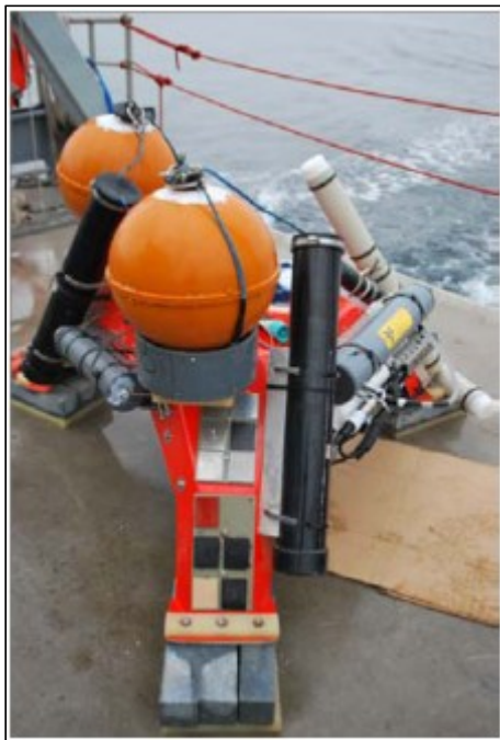
Figure 7 : Echantillons de matériaux attachés à un trépied d'instrumentation [12].
