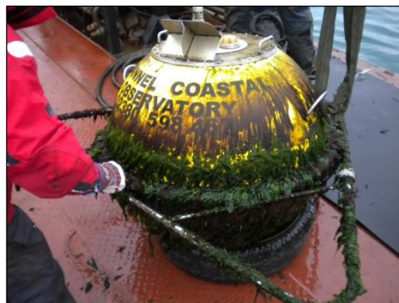
Figure 5. Bouée directionnelle fortement encrassée [46].
