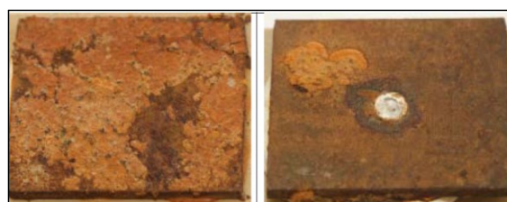
Figure 13 : Corrosion du coupon en acier de construction [12].
