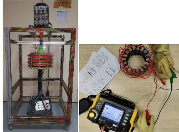
Figure 52 : prototype de banc d'essai pour génératrice à axe vertical (2017, avant la soufflerie). A droite, mise en œuvre d'un contrôleur d'installation pour vérifier l'isolement des enroulements bobinés (Dionysienne à axe horizontal 2020)
