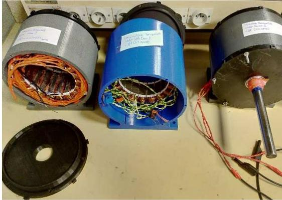
Figure 34 : différentes génératrices de Dionysienne à axe horizontal construites en 2019 et 2020
