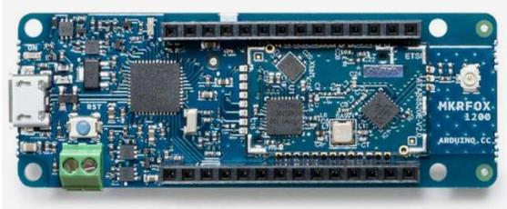
Figure 44 bis : carte "Shield" Arduino MKRFOX1200
