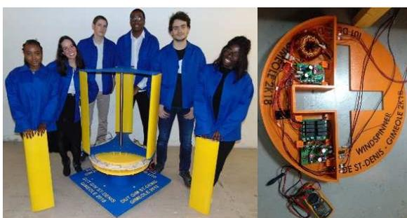
Figure 7 : deux équipes enfin mixtes pour l'édition 2018 à Roanne. La première Dionysienne voit sa génératrice déportée en pied de mât pour améliorer le flux d'air dans la turbine et la seconde son électronique intégrée dans le support avec une fonction de redondance pour améliorer sa disponibilité pendant l'épreuve. Nouvelle victoire à GIMEole pour cette dernière !
