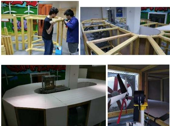
Figure 47 : construction de la soufflerie du GIMaéroLab et Dionysienne en zone d'essai.
