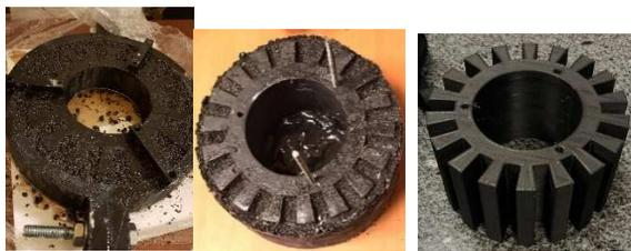
Figure 40 : démoulage du stator en résine et limaille de fer (Dionysienne à axe horizontal 2020). Moules extérieurs et intérieurs (ici à droite) imprimés 3D.
