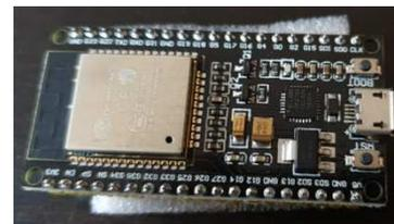
Figure 46 : module NodeESP32 acquis pour commencer les développements (GIMEole2021)
