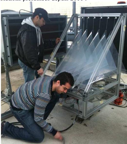
*Figure 1 : Dionysienne "ondulienne" (2011, Cherbourg, Prix de l'innovation). Les voiles, soumises au vent, entraînent dans un mouvement de translation un chariot sur lequel est assemblée une génératrice*
