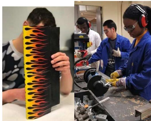
Figure 32 : un revêtement en papier Craft déposé avec de la colle à bois permet ensuite d'augmenter la rigidité de la pale de polystyrène. L'état de surface est amélioré avec une épaisseur de film plastique (incorporant les motifs de décoration ou logos des sponsors). La préparation des tubes de rigidification des pales en polystyrène s'effectue avec des outils électroportatifs
