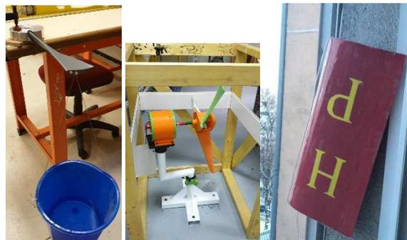
Figure 53 : test de rigidité d'une pale montée sur son support de pales. Au centre, test de résistance aux intempéries d'une demi pale en la laissant tout un hiver accrochée à la fenêtre de l'IUT. A droite, vérification rapide des dimensions de l'éolienne une fois montée à l'aide d'un cadre en bois construit selon les préconisations du règlement (Dionysienne à axe horizontal 2019).
