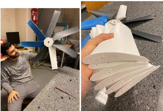
Figure 30 : jeux de pales de différents profils, expérimentés puis rangés. A droite, montage d'une turbine 7 pales (Dionysienne à axe horizontal 2020)
