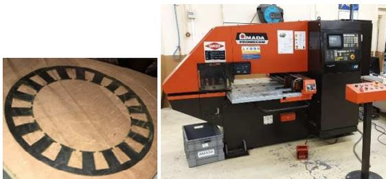
Figure 36 : tôle statorique découpée à la poinçonneuse-grignoteuse puis recouverte d'un vernis isolant au pinceau. A droite, procédé de grignotage de tôles (MOCN Amada Promecam Aries 222) mis en œuvre par un technicien des PT.
