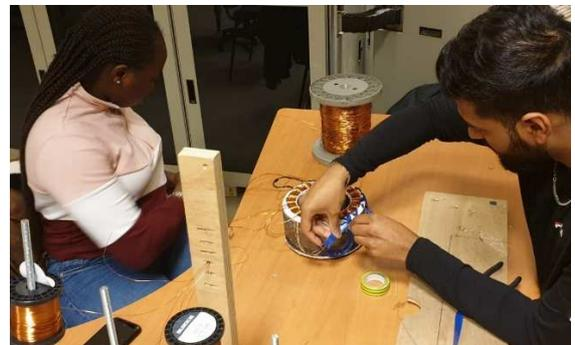
Figure 39 : re-bobinage du stator de la génératrice à flux radial (Dionysienne à axe horizontal 2020) avec protections de fond d'encoches
