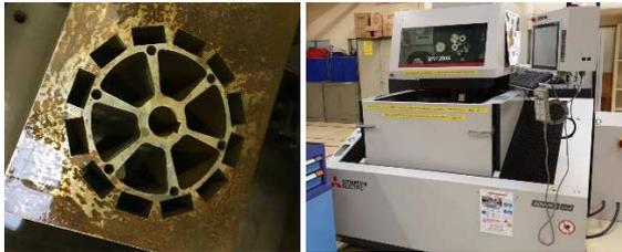
Figure 35 : prototype de rotor en acier massif en cours de découpe avec un procédé d'électroérosion. On observe les logements des 12 aimants permanents à la périphérie du futur cylindre. A droite, le procédé de découpe par électroérosion (MOCN Mitsubishi Electric, Advance type 2) mis en œuvre par un technicien des PT.
