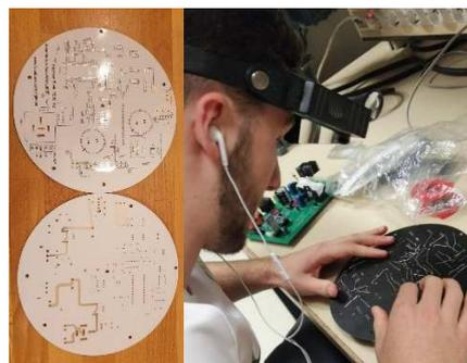
Figure 43 : vue recto/verso des circuits imprimés réalisés via un service en ligne proposé par la plateforme EasyEDA et adaptés à une intégration à l'arrière de la génératrice horizontale. A droite, implantation des composants avant soudure manuelle de la carte électronique (Dionysienne GIMEole2020).
