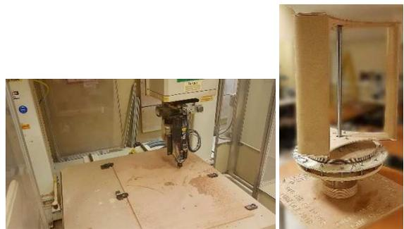
Figure 33 : à droite, une Dionysienne à axe vertical de 2018 réalisée avec de nombreuses pièces en bois usinées avec la MOCN "Thermwood 67"
