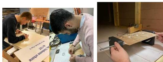
Figure 54 : mesure de l'angle de décrochage aérodynamique des pales de la Dionysienne à axe vertical par observation en soufflerie d'un petit fil fixé au profil
