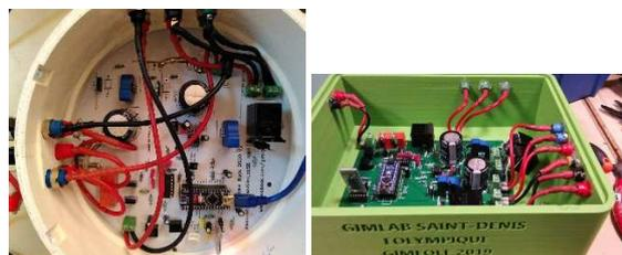
Figures 44 : cartes électroniques montées dans leur coffret respectif, adapté et imprimé 3D (Dionysiennes à axe horizontal 2020 et à axe vertical 2019)
