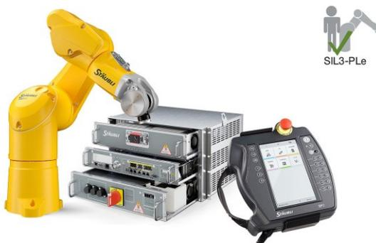
Figure 6 : Les différentes parties d'un robot : le bras, les tiroirs, le « pendant »
