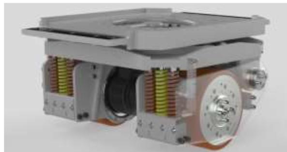
Ces unités motrices vont permettre à l'AGV de réaliser différents types de déplacement :
