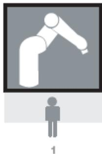
Dans ce cas de figure, le robot est enfermé dans une cellule « traditionnelle » avec des séparations physiques (barrières). Le contact est impossible entre l'Homme et le robot.
