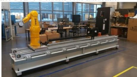
Figure 13 : cellule robotisée mobile sur 7<sup>ème</sup> axe au Cetim [12]
