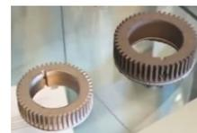
Figure 15 : impression 3D métallique : biscuit (à droite) et pièce terminée (à gauche) [12]
