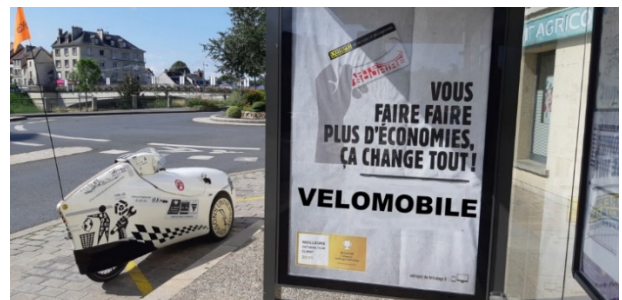
Figure 3 : Vélo mobile 50kg, autonomie 200 km à 45km/h
