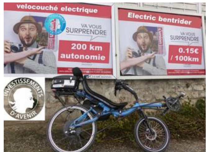
Figure 4 : Vélocouché (35kg, 3KW, 200km autonomie à 45km/h)
