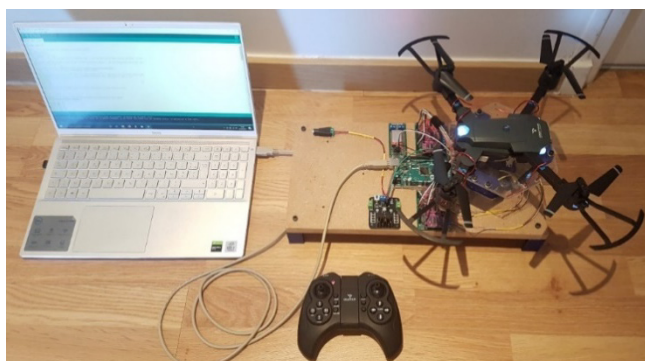
Figure 14 - Dispositif expérimental de mesure des performances d'un drone
