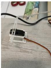
Un servomoteur et son palonnier permettent de contrôler la tension sur le câble.
