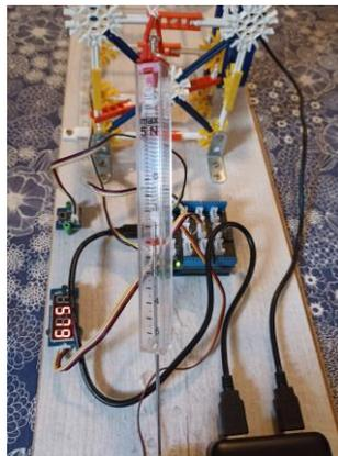
On peut adjoindre un dynamomètre (5 Newtons) pour mesurer la tension exercée par les câbles.
