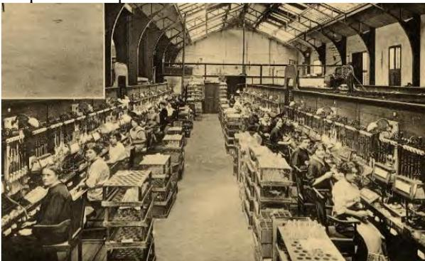
**Figure 6 :** atelier de production du vide dans les lampes
