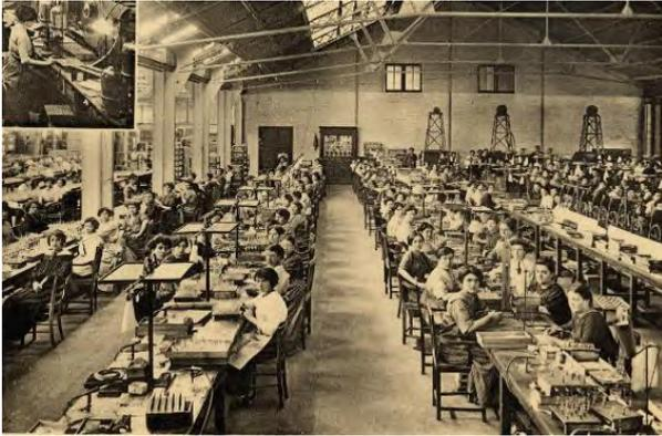
**Figure 5 :** fabrication des tiges et montage des éléments (+ en vignette, en haut à gauche : carburation des filaments carbone)
