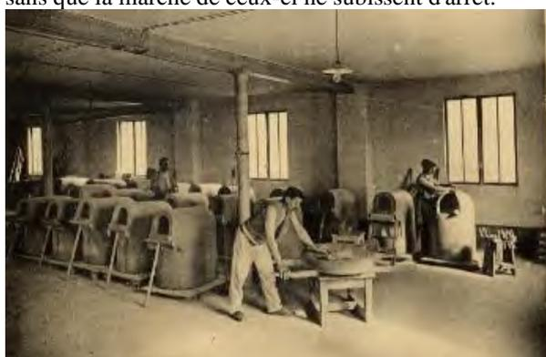
Figure 3 : fabrication des pots pour les fours
