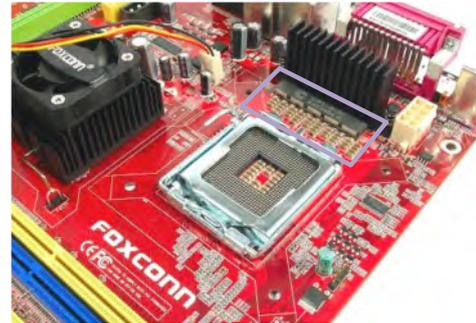
Figure 12 : Exemple de carte mère utilisant une structure de VR de nouvelle génération
