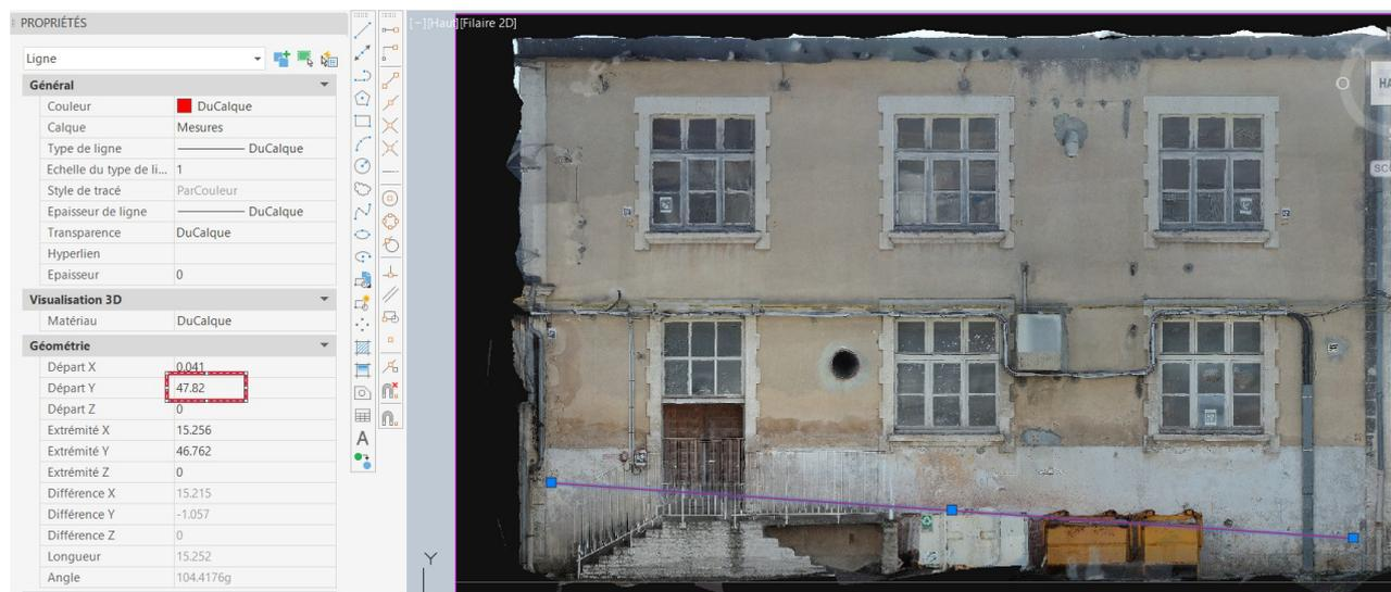
Si l'altitude de l'autre cible de la ligne de mise à l'échelle a été déterminée par nivellement direct ou levé au tachéomètre, elle peut servir pour un contrôle. Ici l'altitude de la cible est de 46,76 m que l'on retrouve bien comme Y à l'extrémité de la ligne de contrôle.
