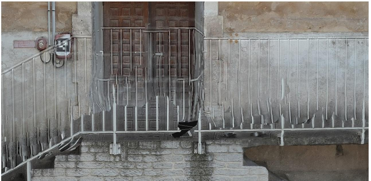
On peut effectuer un nettoyage du modèle en effaçant les faces situées sur les bords qui sont incohérentes par exemple en bordures de la façade (à gauche ou à droite) ou en bordure du toit en haut : dans l'onglet *Édition* (situé à droite) commande *Sélection/Main libre* puis outil *Lasso*, sélectionner les faces à effacer qui apparaissent en rouge puis appuyer sur la touche *Suppr* pour les effacer :
