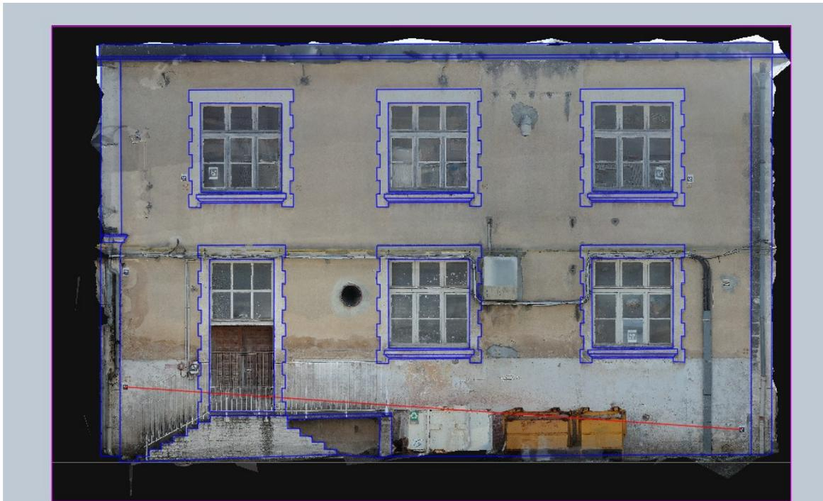
On peut délimiter l'orthophoto pour que la partie extérieure à la façade ne soit pas visible : commande *Delimimage*, sélectionner l'orthophoto, valider pour Nouveau contour, taper *P* pour Polygonal puis indiquer les points du contour de l'orthophoto :
