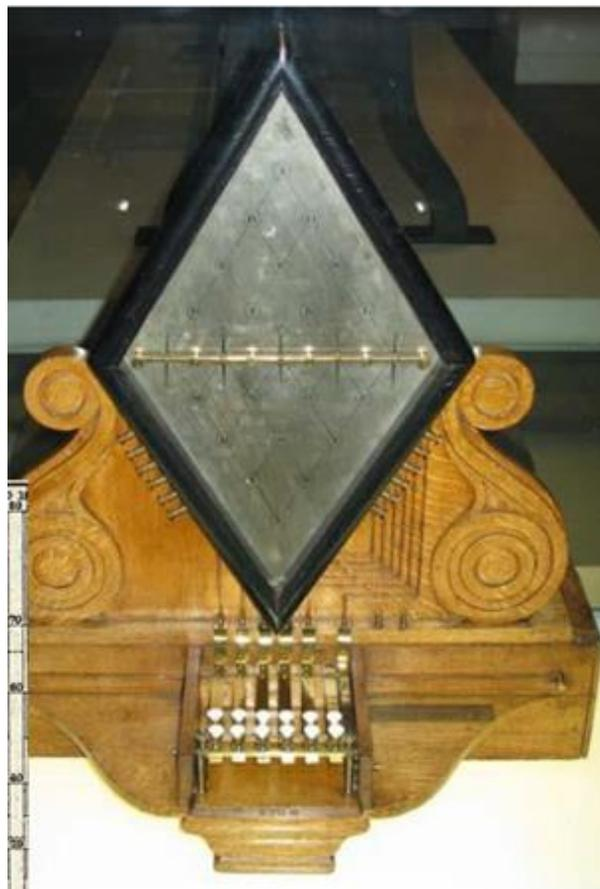
*Figure 9 : Cooke et Wheatstone ont utilisé l'effet électromagnétique pour déplacer des aiguilles dans leur dispositif télégraphique. Celui-ci a cinq aiguilles, qui peuvent pointer vers n'importe quelle lettre de l'alphabet. Crédit Wikicommons*
