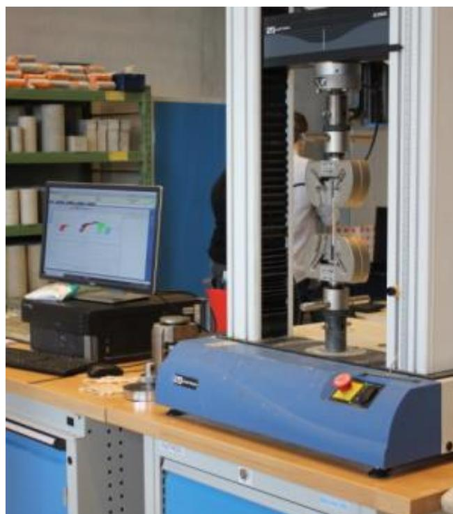
Figure 1 : Dispositif d'essai en traction des bâtonnets en bois, source [1]
