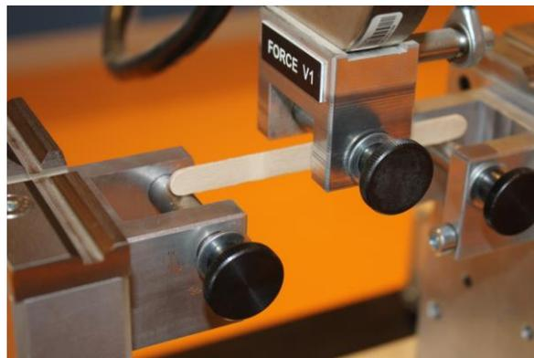
Figure 5 : Essai de flexion 3 points sur un bâtonnet simple axe fort
