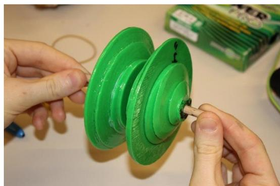
Figure 15 : Les contrepoids montés sur l'arbre
