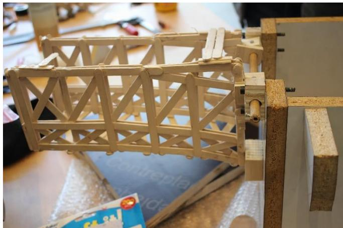
Figure 9 : Esquisse de la solution pour la liaison pivot et réalisation d'un prototype
