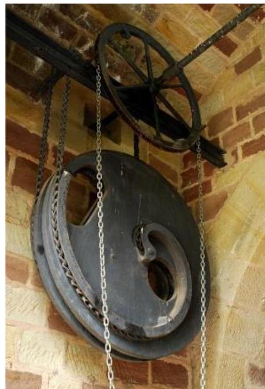
Figure 12 : Schéma du mécanisme du pont-levis système Devèze du fort de Boulémont (Vosges) et détail du système au fort de Sanchey (Vosges), source [6]
