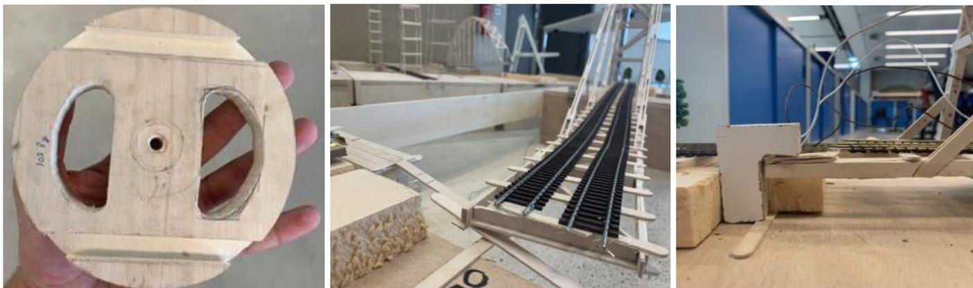
Figure 18 : Poulie motrice usinée Figure 19 : Guidage du tablier à la fermeture Figure 20 : Reprise d'effort
