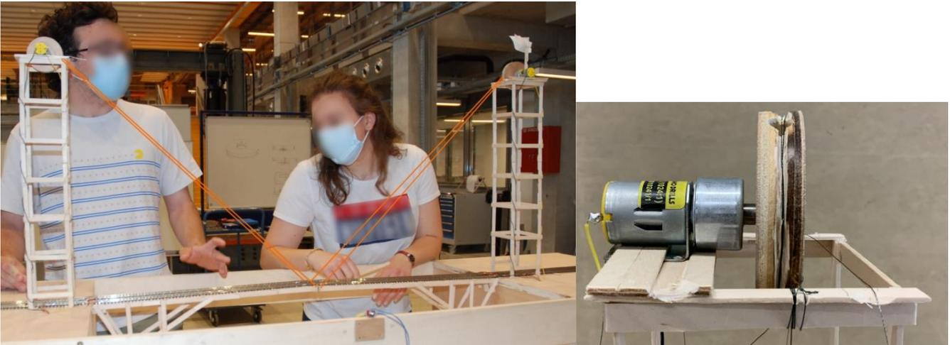
Figure 7 : Visualisation des poulies et du câbles sur la maquette, détail du montage moteur/poulie
