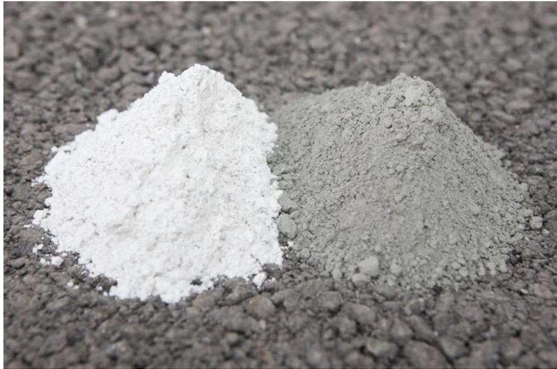
Figure 2 : Laitiers de haut fourneau (S) à gauche et un ciment Portland à droite, source [11]
