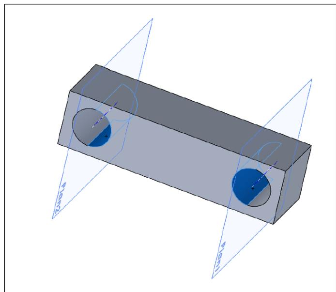
Créer un point d'esquisse au milieu d'un cylindre qui sera l'origine du système de coordonnées pour la répartition de pression parabolique.
