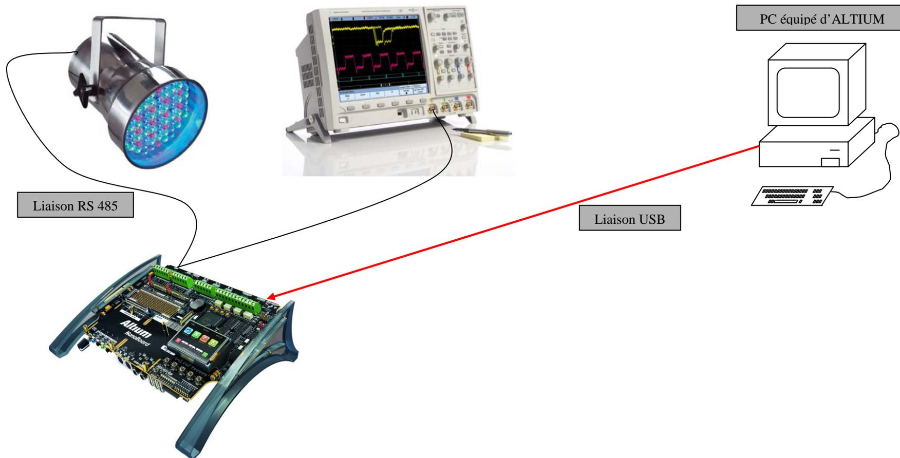
A6 : Schéma « Open Bus » à mettre en place pour le projet.
