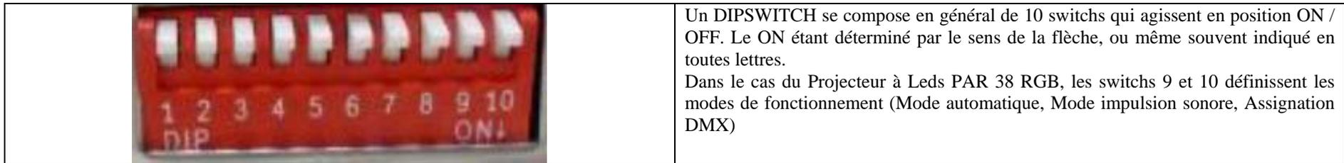
Mode Automatique : DIP#9 OFF et DIP #10 OFF
