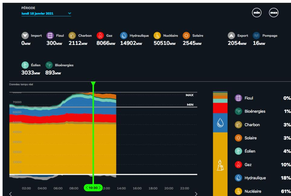
Figure 3 : Production d'électricité par filière pour le 18 janvier 2021, en MW, source RTE [3]
