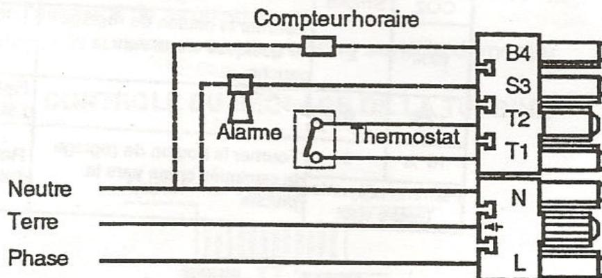
Raccordement à effectuer sur les fiches mâles du connecteur monté sur le brûleur (figure ci-contre), ou enficher le connecteur de la chaudière sur le connecteur mâle.
