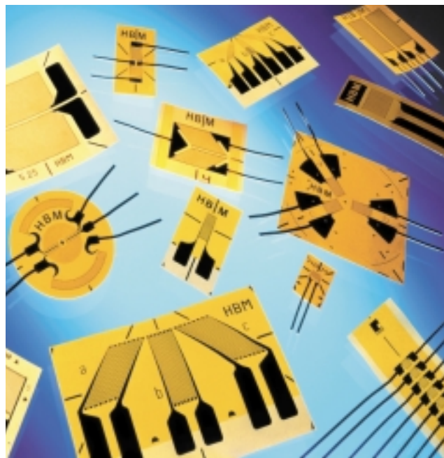
Les jauges de contraintes sont constituées d'un fil résistant très fin imprimé ou collé sur un support isolant. Elles traduisent en variation de résistance électrique la déformation du corps d'épreuve sur lequel elles sont collées.
