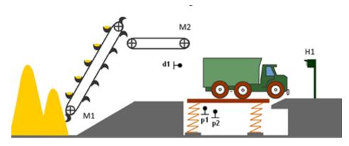
Le camion est placé sur un système de pesée (en contact avec d1). Quand le camion est en partie chargé, l'action de la plateforme sur le détecteur p1 doit stopper le tapis 1, et maintenir le tapis 2 en action.
