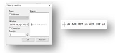
En choisissant **O Connexion**, il sera possible d'écrire l'équation logique de la réceptivité en langage ladder en commençant à gauche par une barre d'alimentation et en rebouclant sur la transition.
