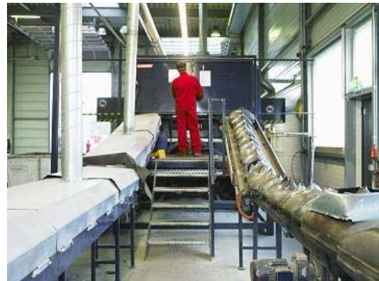
Positionnement du tube dans la machine de découpe
