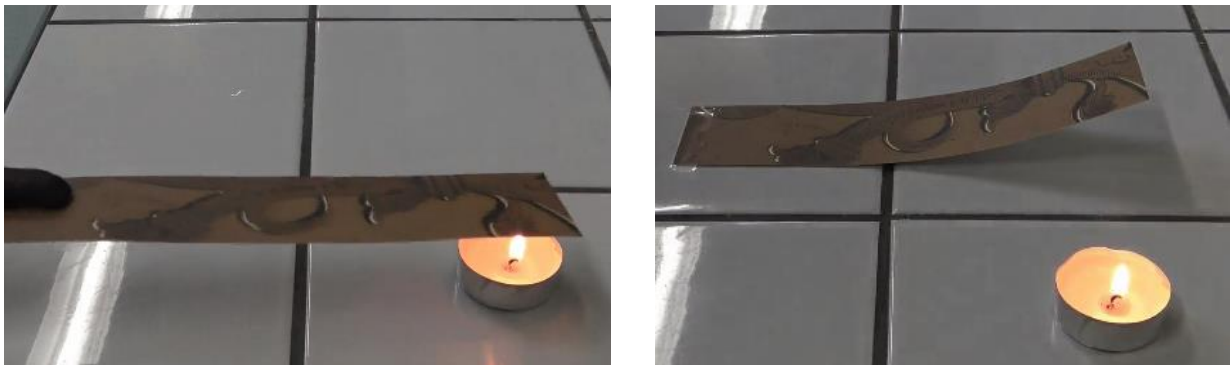
Figure 4 : Images extraites de la vidéo de l'expérience avec le bilame 2 : début et fin de l'expérience
