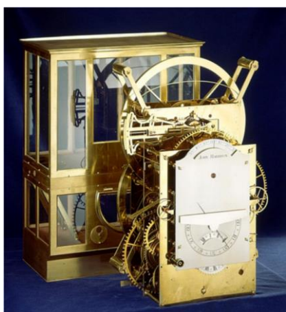
Figure 6 : Photographie du chronomètre H3 de John Harrison, première utilisation connue d'un bilame, source [2]
