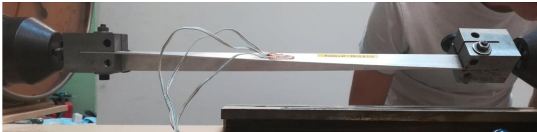
Figure 22 : Déformée de la cornière durant l'essai en torsion pure
