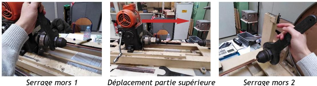
Figure 8 : Étape 1 - installation de la barre testée
