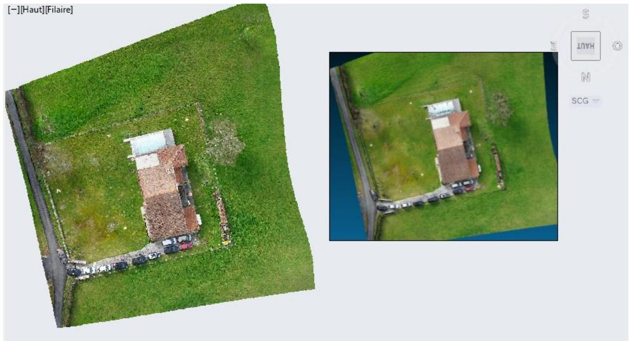
La méthode rigoureuse pour mettre l'orthophoto à l'échelle et en position serait d'effectuer une adaptation d'Helmert 2D sur les points calage : les cibles relevées au GNSS.
